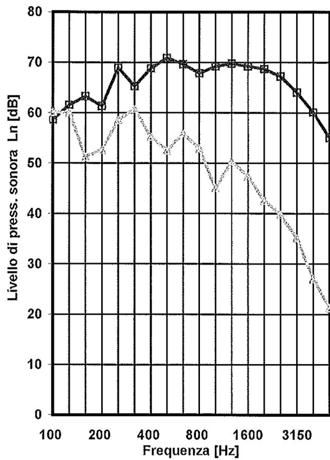
■ CURVA SPERIMENTALE: SOLAIO SENZA RIVESTIMENTO (S)
